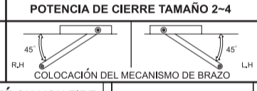
CONFIGURATION C - FIXATION DU LINTEAU - DU CÔTÉ OU L'ON TIRE APLICACIÓN C - FIJACIÓN DE MONTANTE - LADO DE TRACCIÓN
