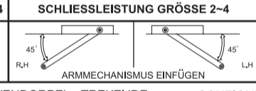
TOEPASSING C - BEVESTIGING AAN BOVENDORPEL - TREKZIJDJE APPLICAZIONE C - FISSAGGIO AD ARCHITRAVE - LATO TIRARE
