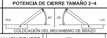
CONFIGURATION D - FIXATION DE LA PORTE - DU CÔTÉ OU L'ON Pousse APLICACIÓN D - FIJACIÓN DE PUERTA - LADO DE EMPUJE
