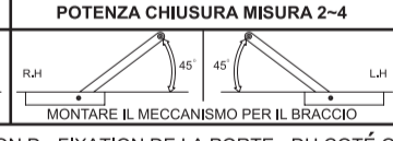
CONFIGURATION D - FIXATION DE LA PORTE - DU CÔTÉ OU L'ON Pousse APLICACIÓN D - FIJACIÓN DE PUERTA - LADO DE EMPUJE
